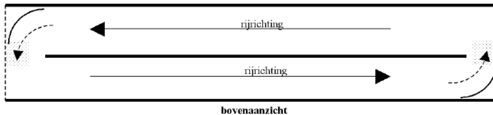
Figuur 1 Luchtcirculatie door tegengestelde verkeersbeweging
